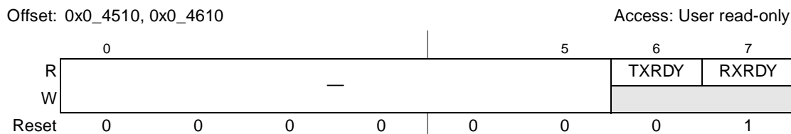
Figure 16-15. DMA Status Register (UDSR)
